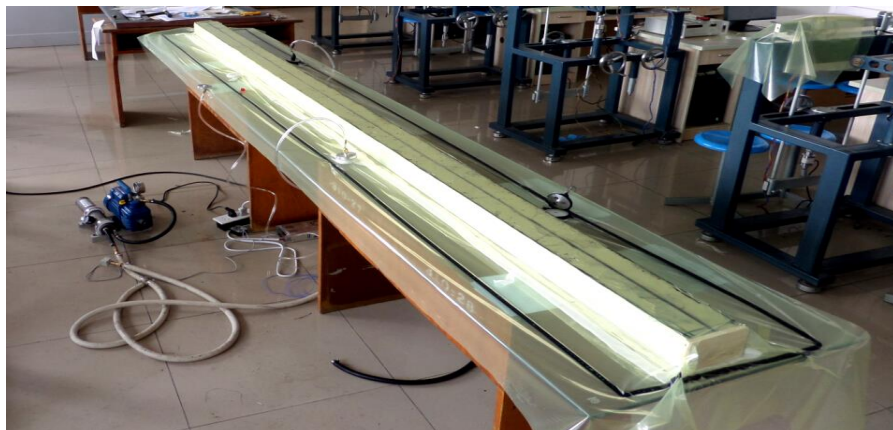
机翼大梁常温真空固化工艺
